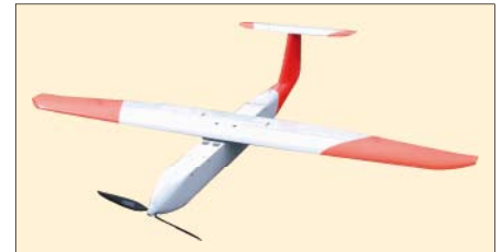
Abb. 1: Das Kleinflugzeug Carolo P 200 • Startgewicht 6 kg; Nutzlast 0,8 kg; • Spannweite 200 cm; • Reisegeschwindigkeit ca. 20 m/s; • Flugzeit ca. 60 min; • maximale Flughöhe 2 500 m
